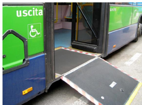
Uno dei pullman attrezzati con pedana per l'accesso delle carrozzelle
